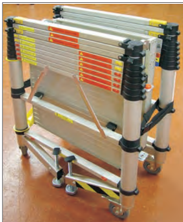
1. Hauptbaugruppe mit zusammengeklappter Arbeitsbühne
